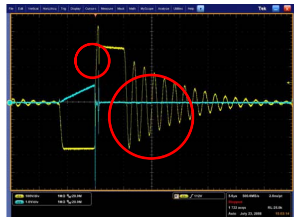
[ Abb. 11 ] Strom und Spannung eines markttypischen Netzteils. Es ist ein sichtbar deutlich höherer Störanteil zu erkennen (rot eingekreist). Die Spannungswellenform ist gelb dargestellt, die Stromwellenform in blau.
