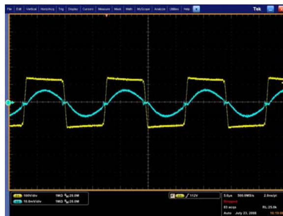
[ Fig. 12 ] Alimentatore Yamaha con full resonance switching. Forme d'onda ben definite e naturali con disturbo di switch minimo. La forma d'onda della tensione appare in giallo, mentre quella della corrente in blu.
