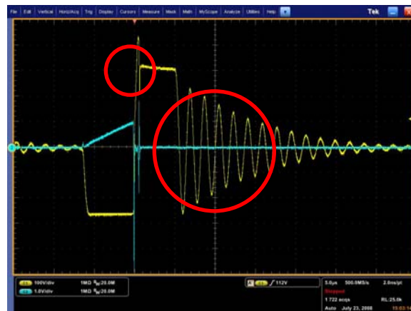
[ Fig. 11 ] Corrente e tensione di un alimentatore tipico della concorrenza. Si noti la maggiore quantità di disturbo (evidenziata da un circoletto rosso). La forma d'onda della tensione appare in giallo, mentre quella della corrente in blu.
